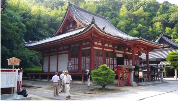
鎌倉時代1321年（元応3年）に建立された仏堂。和様建築に鎌倉時代以降の新様式である大仏様（だいぶつよう）、禅宗様を加味した折衷様建築の代表例とされている。内部の外陣に見られる輪垂木（わだるき）を用いたアーチ型の天井は、近世の黄檗宗寺院の建築にしばしば見られるものだが、中世には珍しい。
